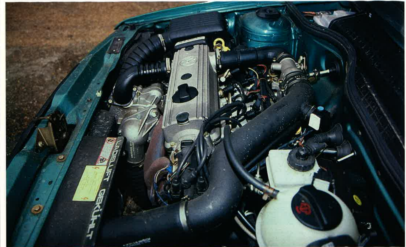
Sur cette photo, on remarquera à gauche, la canalisation d'arrivée de l'huile pour les paliers du compresseur G. De la même manière, on note, à droite, au-dessus du boîtier papillon, la tringlerie qui commande la fermeture du by pass.
