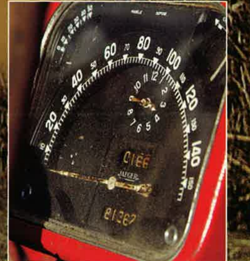
Dès 1939, le client pouvait choisir entre un moteur plus économique, le « 7 Eco », et un second plus performant, le « 11 Perfo », développant 56 ch. Dans ce cas précis, le compteur de vitesse passait de 130 plus 10 à 140 plus 10.
