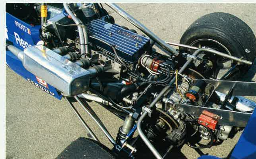
La restauration de cette voiture fut réalisée par Hervé Delaunay. Le téléphone est là. À droite, l'ensemble moto-propulseur Renault/Hewland. Le moteur en aluminium est à injection, et les soupapes sont surdimensionnées. Rappelons que la coque de la Martini Mk 21 B, était directement dérivée de celle de la Formule Renault.
