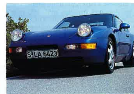
Les prises d'air sont pratiquement toutes situées sous le bouclier.
