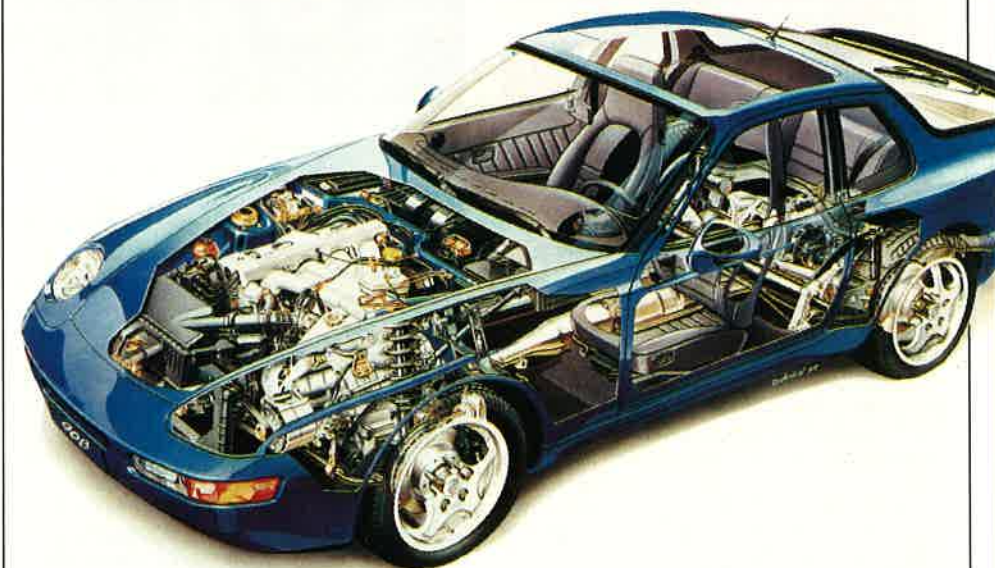
Le moteur émerge d'un logement qui fait instinctivement penser au compartiment avant de la 911. On remarque l'énorme collecteur en alliage avec ses gros conduits ainsi que sur le débitmètre à fil chaud du LH Jetronic.
