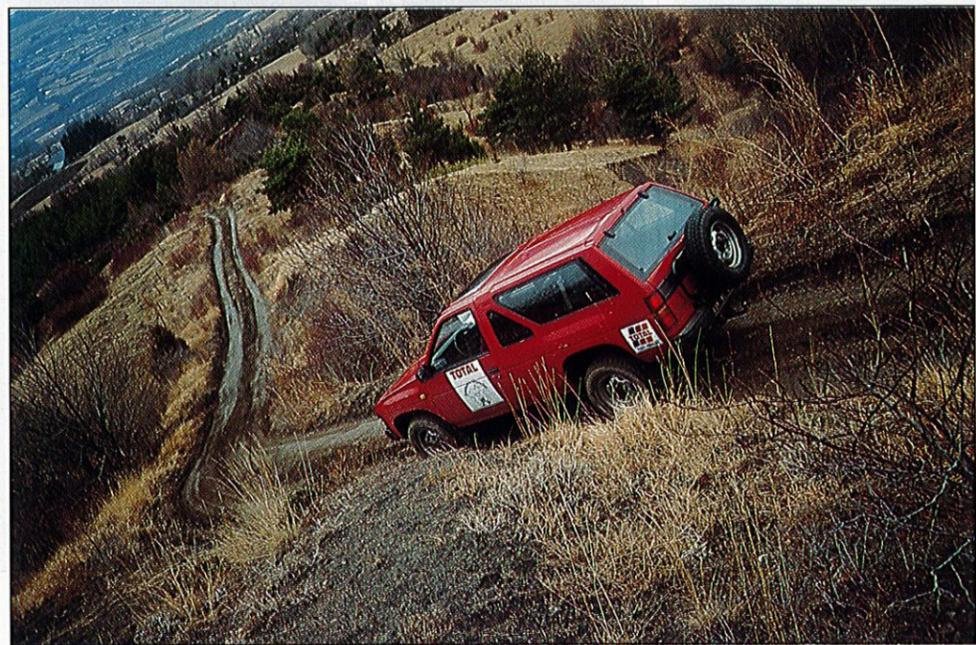
**3. Malgré sa monte pneumatique en pneu Desert, le Terrano passe fort bien les terrains gras. Seule la boue profonde risque de le bloquer avec l'absence de blocage de différentiel.**
