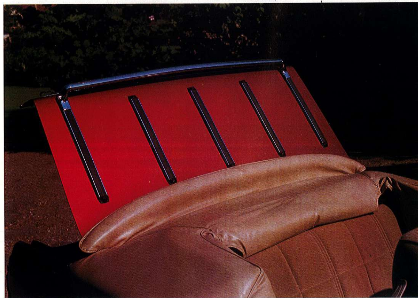
Le coffre du modèle 85 était orné d'un porte-bagages chromé dont l'utilité est douteuse mais le look d'enfer... Le couvre capote, assez difficile à manier s'agrafe sur le capot mais n'empêche pas l'ouverture de celui-ci.
